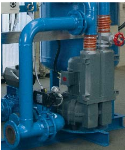
Figure: Detail „Blower Unit“
